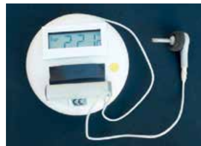
Métraux tympane thermometer: thermistor based tympane thermometer met een 18 mm geïsoleerde tympaneprobe (3)
